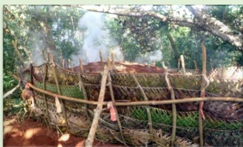
La construction d'une meule moyenne faisant 5\*5 mètres sur 1,2m de hauteur (nécessitant environ 30 m<sup>3</sup> de bois) demande plusieurs jours de travail entre le terrassement du site qui servira à recouvrir et étanchéifier au final le dispositif, la confection de l'enceinte à l'aide d'un clayonnage de bois et de natte de cocotier « M'bangà » et l'empilage du bois brut ; le choix des essences utilisées est souvent sans importance.
